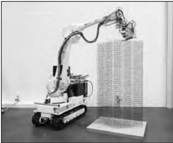
Рис. 3. Робот In-Situ Fabricator інституту ETH Zurich (м. Цюріх) [11]
